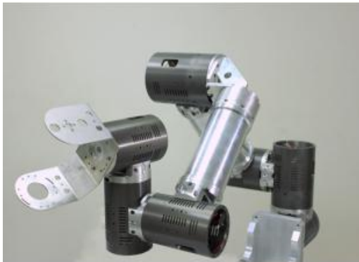
圖一 肩膀及手腕具有偏移的 7 自由度模組化機械手臂，這是由本中心設計的全新雙手臂機器人的其中一隻。
